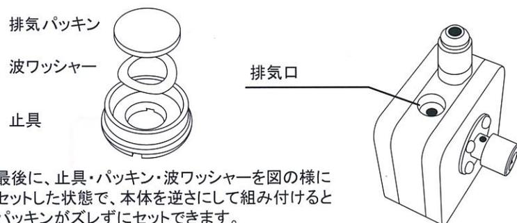
最後に、止具・パッキン・波ワッシャーを図の様にセットした状態で、本体を逆さにして組み付けるとパッキンがズレずにセットできます。
